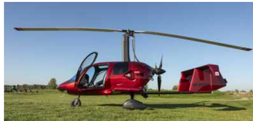
Nowy Argon GTL 916 ma dłuższy kadłub z dopracowanym aerodynamicznie omaskowaniem silnika
