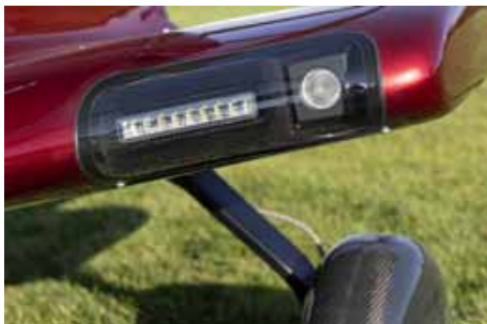
W skrzydełkach zabudowano światła kołowania i lądowania (LED)
