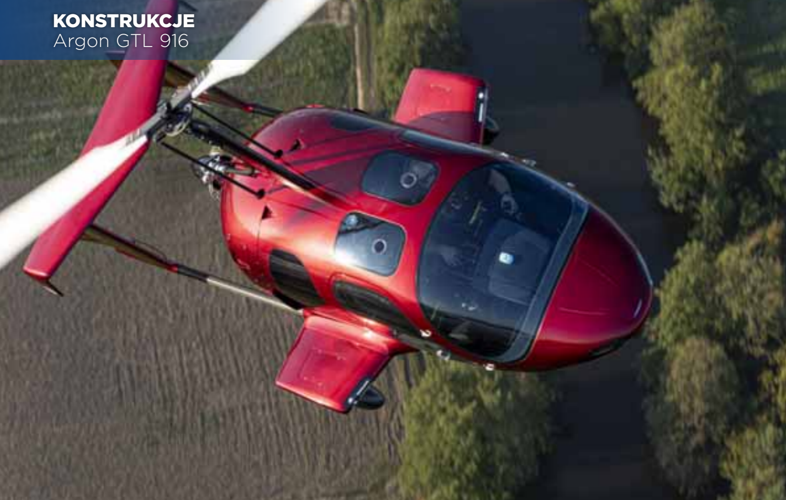
Rozpiętość skrzydeł dobrano doświadczalnie, zwiększyły one dwukrotnie doskonałość szybowania przy zdjętej mocy
