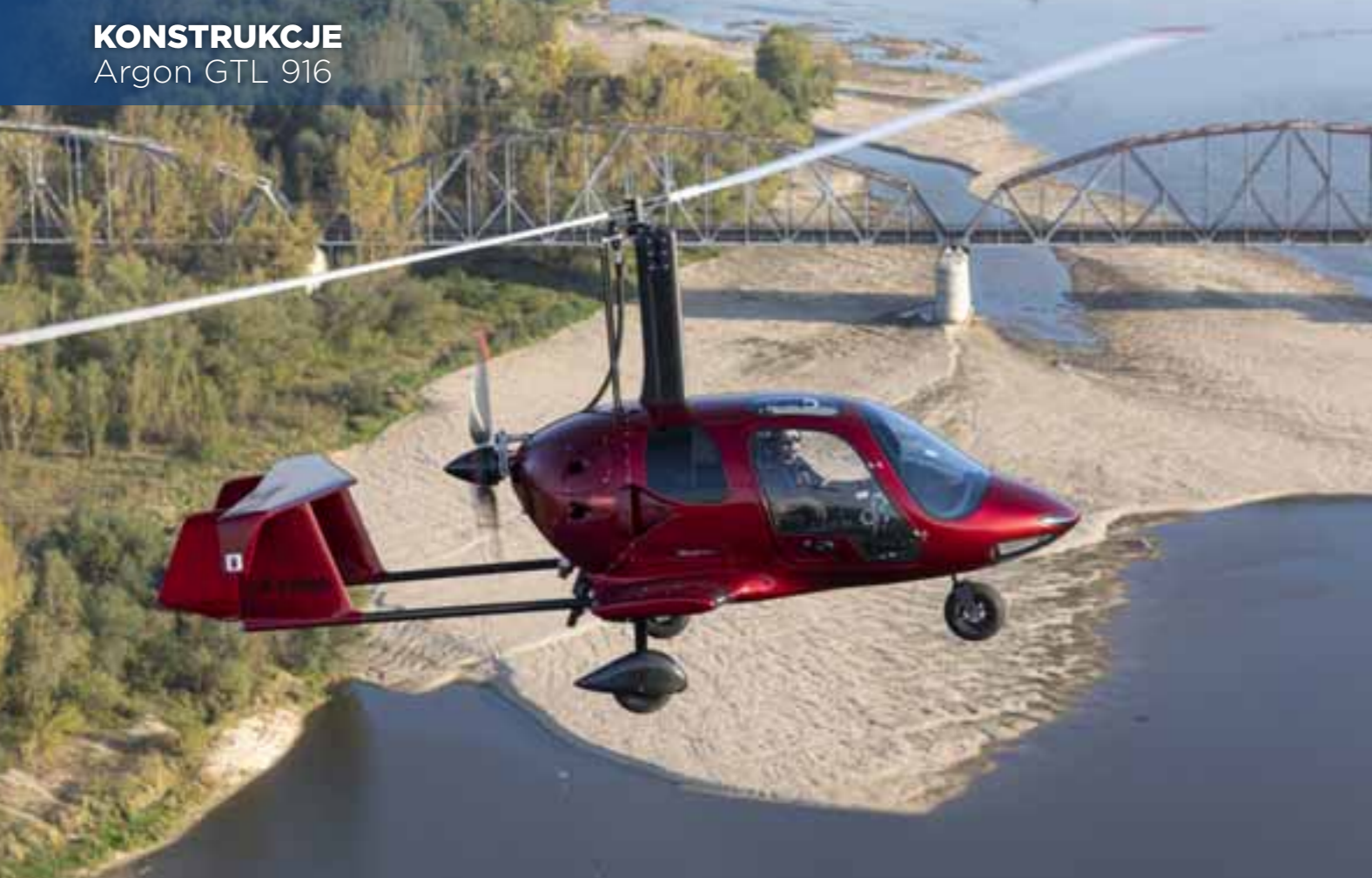
Kolory wiatrakowców z Manufaktury są bardzo oryginalne. Jest możliwe dzięki zastosowaniu kompozytów termoutwardzalnych.
