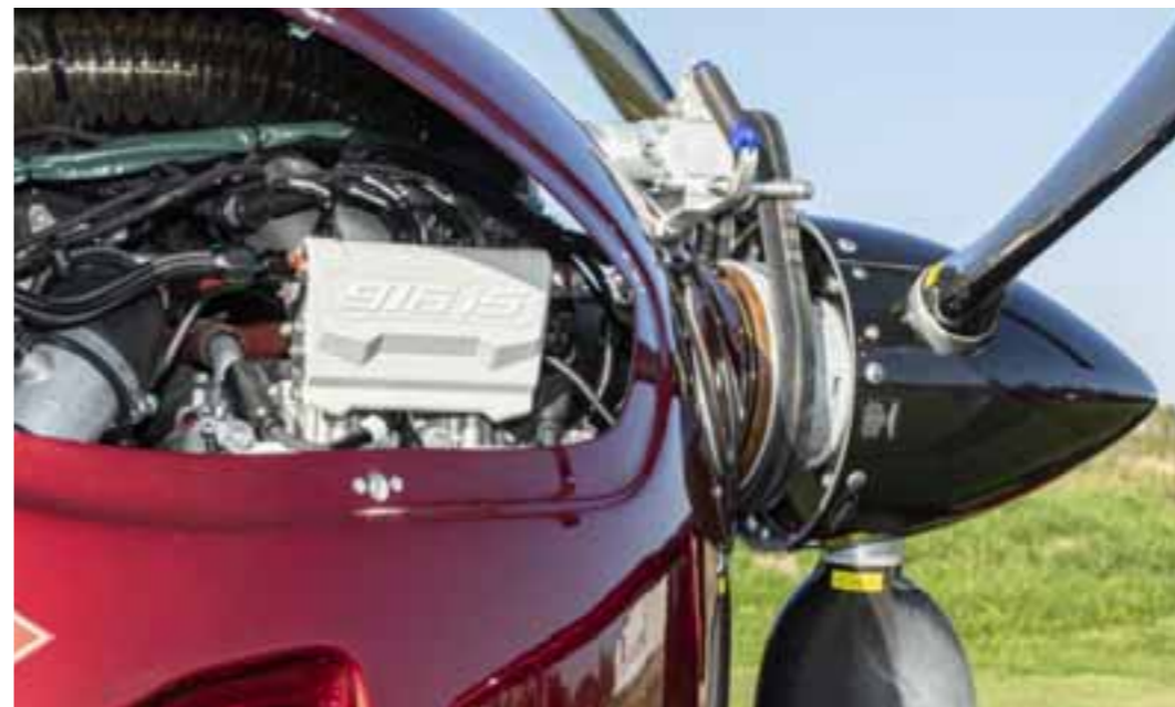
Pokrywy wzierników zapinane są na zamki dżus
