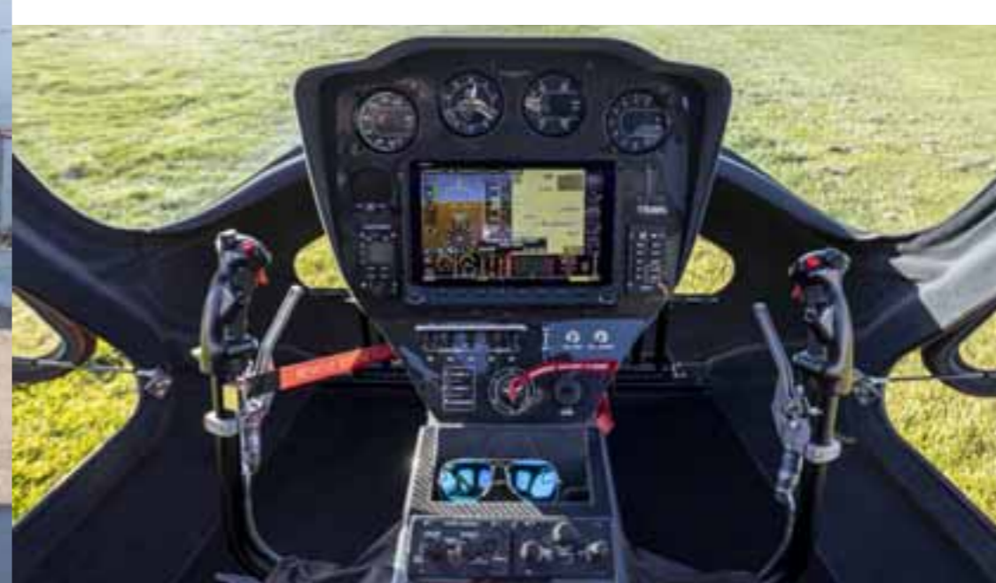
Wśród wyposażenia tablicy przyrządów uwagę zwraca 3-osiowy autopilot
