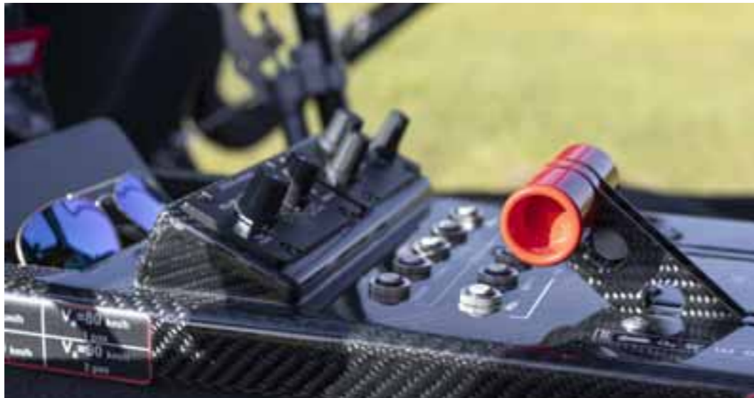
Śmigło ma zmienny skok, ale do sterowania mocą służy tylko jedna dźwignia
