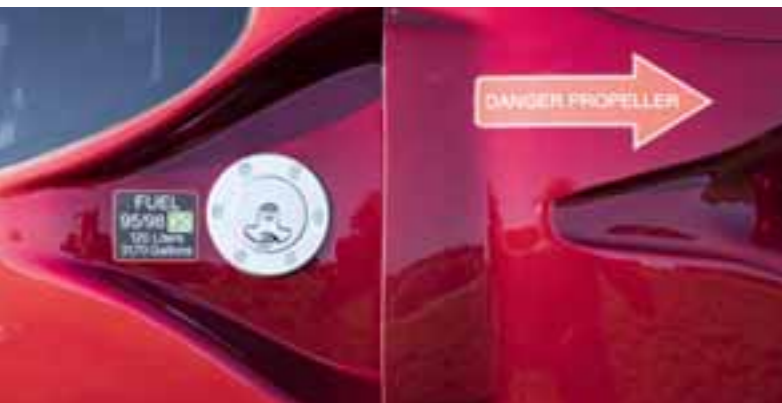
Zbiornik paliwa na 120 litrów zapewnia zasięg 1000 km
